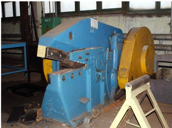
Предназначены для резки длинномерного металлического лома и отходов в холодном состоянии.
